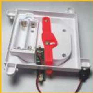
2. Den Schieber nach rechts schieben und die Platine mit dem Batteriekabel wie im Bild gezeigt durch die Öffnung schieben
