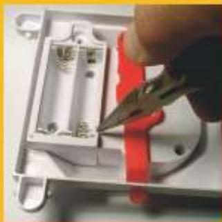
1. Mit einer Spitzzange ein kleines Eck des Batteriefachs für die Kabeldurchführung herausbrechen
