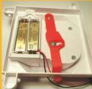
3. Beide Platinen mit Polung wie im Batteriefach gekennzeichnet einsetzen und das Kabel durch das ausgebrochene Eck legen
