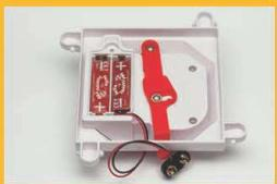
3. Beide Platinen mit Polung wie im Batteriefach gekennzeichnet einsetzen und das Kabel durch das ausgebrochene Eck legen
