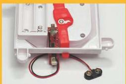
2. Den roten Hebel nach rechts schieben und die Platine mit dem Batteriekabel wie im Bild gezeigt durch die Öffnung führen
