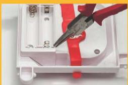
1. Mit einer Spitzzange ein kleines Eck des Batteriefachs für die Kabeldurchführung herausbrechen
